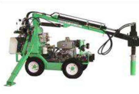
Figure 11 – Machines pour l'installation des TECHNO PIEUX®
