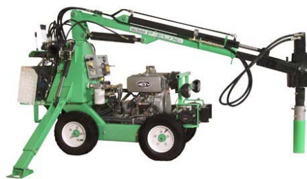
Figure 4 – Machines pour l'installation des TECHNO PIEUX®
